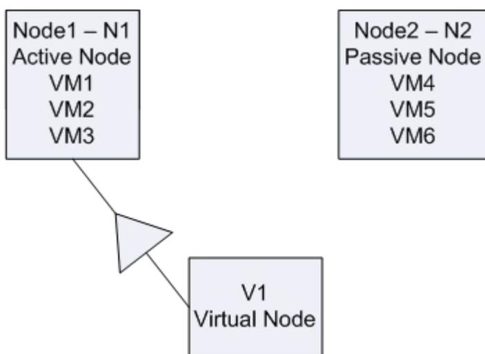
Em um cenário ideal, o nó virtual V1 do agrupamento direciona o tráfego de rede para o nó ativo (N1). Quando ocorre tolerância a falhas, o nó virtual V1 do agrupamento direciona o tráfego de rede para o nó passivo (N2) e todas as VMs no nó ativo (N1) são movidas para o nó passivo (N2).
