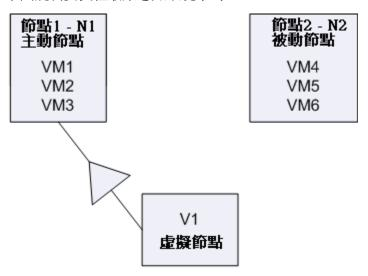
在理想案例中,虛擬叢集節點 V1 會將網路流量導向主動節點 (N1)。 發生容錯轉移時,虛擬叢集節點 V1 會將網路流量導向被動節點 (N2),主動節點 (N1)中的所有 VM 則會移至被動節點 (N2)。
