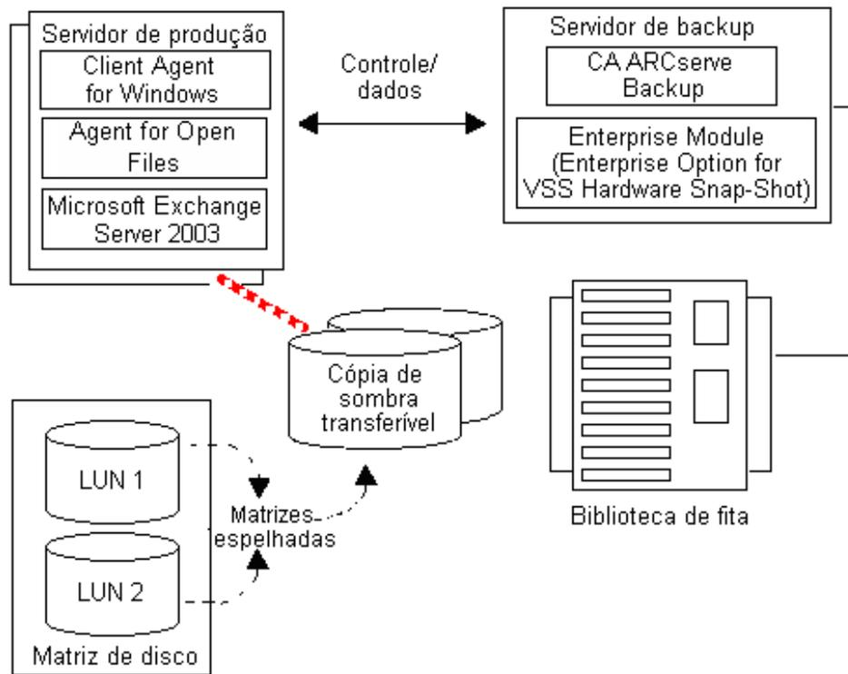
**Observação:** a linha tracejada representa a conexão lógica entre o Microsoft Exchange 2003 Server e os dados clonados no volume da cópia de sombra transportável.
