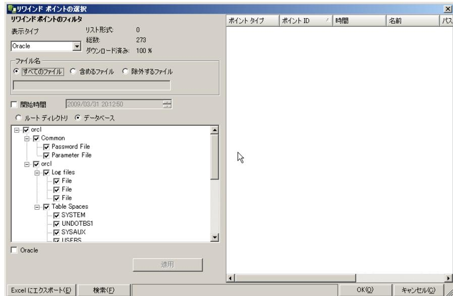
[リワインドポイントの選択]ダイアログボックスにすべてのリワインドポイントのリストが表示されます。これには、システムおよびユーザ定義のブックマークによって自動的に登録されたフォルダやファイルの変更も含まれます。
