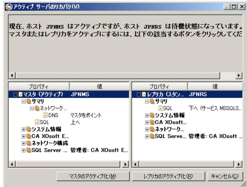
**重要:** 障害発生時の正規のスイッチオーバーで、ユーザが一定期間レプリカサーバにリダイレクトされた場合には、マスタサーバをアクティブにする前に、レプリカサーバでのすべての変更をマスタにレプリケートする必要があります。このような状況で「アクティブサーバのリカバリ」を使用すると、データが失われます。
