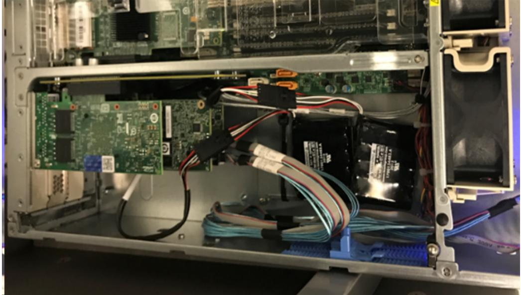
7. 將 *MegaRAID Controller 9380-8e* 托架固定到系統的底座。
