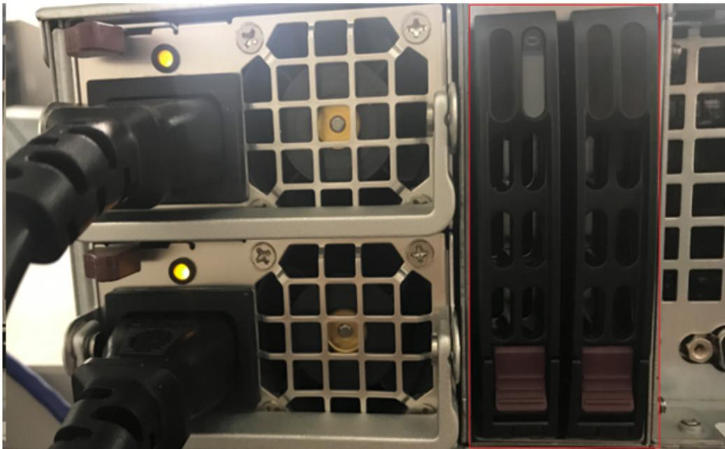
11. 連接設備擴充架的電源線，並開啟設備擴充架的電源。
