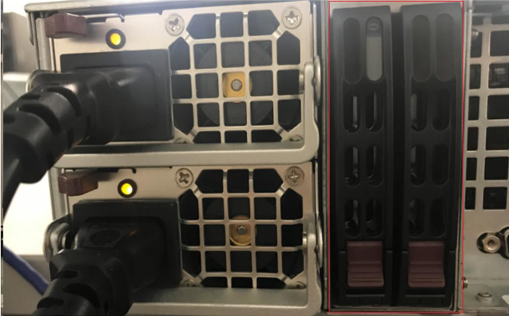
11. Conecte los cables de alimentación del estante de expansión del dispositivo y encienda el estante de expansión del dispositivo.
