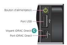
Le voyant iDRAC Direct s'allume pour indiquer que le port est connecté et qu'il est utilisé par le sous-système iDRAC.
