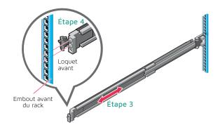
REMARQUE: pour retirer les rails, ouvrez le loquet avant et dégagez le rail de la bride. Tirez complètement sur le rail vers l'avant pour libérer l'embout arrière du rail de la bride.
