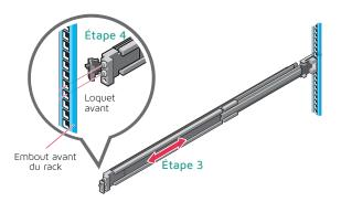
REMARQUE: pour retirer les rails, ouvrez le loquet avant et dégagez le rail de la bride. Tirez complètement sur le rail vers l'avant pour libérer l'embout arrière du rail de la bride.
