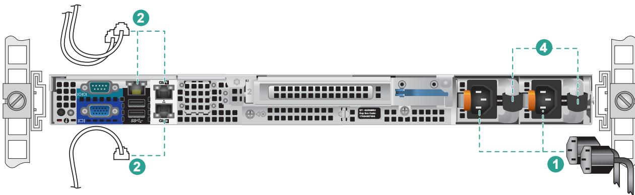
**步骤 1** 连接电源线。
