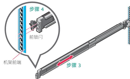
**注意：**确保快速导轨组件不仅在机架中前后对齐，而且在左右两侧高度平齐，以进行正确对齐来安装设备。
