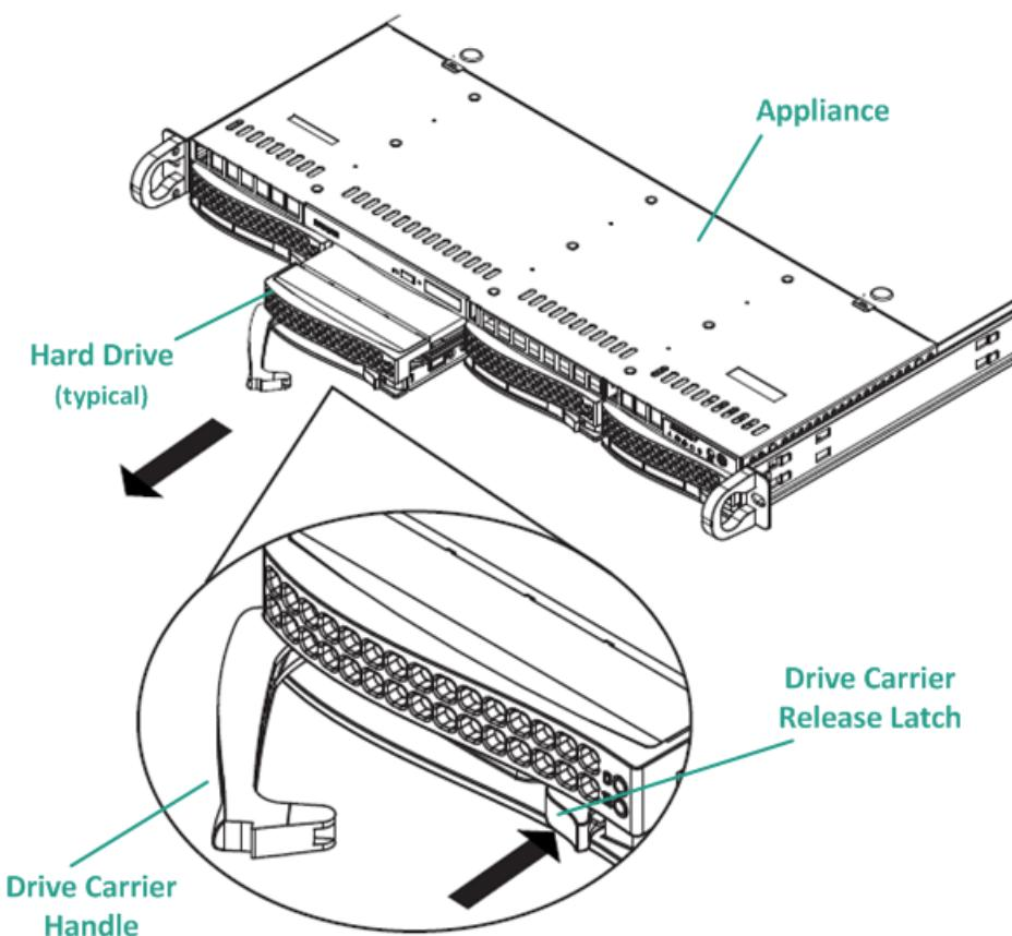
3. 使用把手，從設備前面拉出磁碟抽取盒。硬碟機會裝載在磁碟抽取盒中，以便簡化從設備移除和更換它們的作業。這些載具也有助於提升磁碟機槽的空氣流通。
