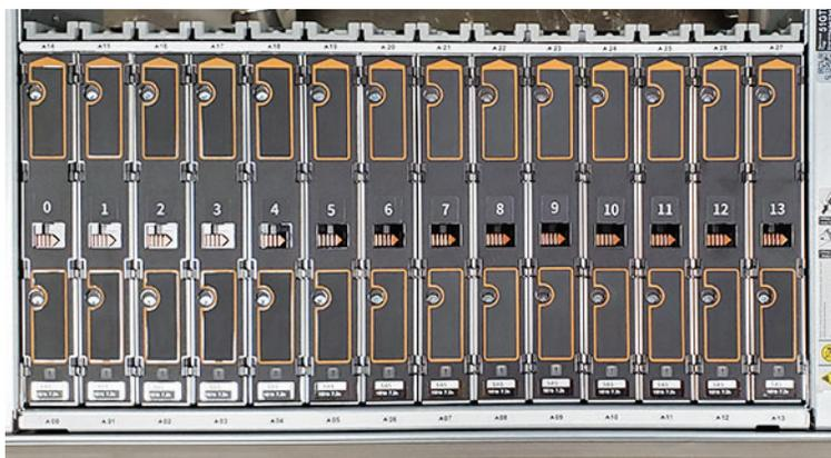
Diese Abbildung zeigt ein Beispiel für eine teilweise bestückte Schublade mit Laufwerkbezeichnung.
