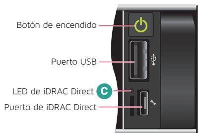
El indicador LED de iDRAC Direct se enciende para indicar que el puerto está conectado y que se está utilizando como parte del subsistema de iDRAC.
