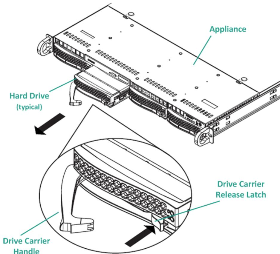
3. Con el asa, tire hacia fuera del soporte de la unidad desde la parte delantera del dispositivo. Los discos duros están montados en soportes de unidad para facilitar su extracción del aparato y su sustitución. Estos soportes también facilitan la adecuada ventilación de las unidades.
