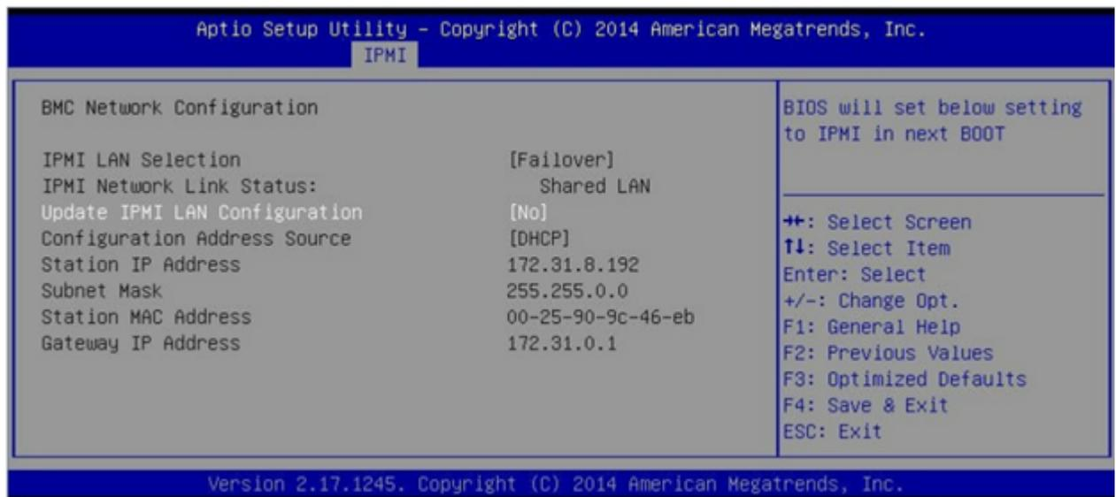
4. Compruebe que la dirección IP sea correcta. Se puede conectar a la interfaz de IPMI mediante el explorador web solo si el servidor está en la misma red.
