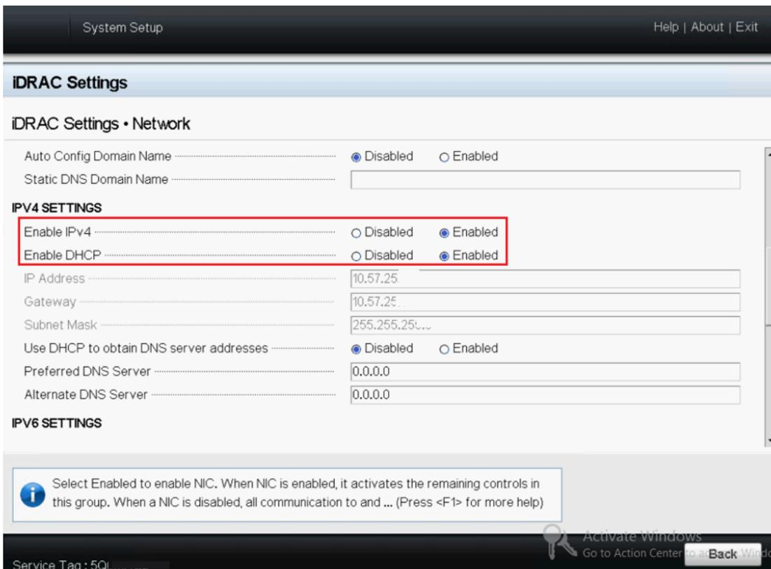
**Nota:** Si desea establecer una dirección IP estática para la red dedicada de iDRAC, establezca **Enable IPv4** en **Enabled** y **Enable DHCP** en **Disabled**. Configure la dirección IP, la puerta de enlace y la máscara de subred conforme a la configuración de red.
