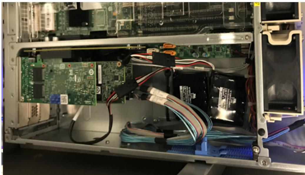
7. Asegure el soporte del *controlador MegaRAID 9380-8e* en el chasis del sistema.
