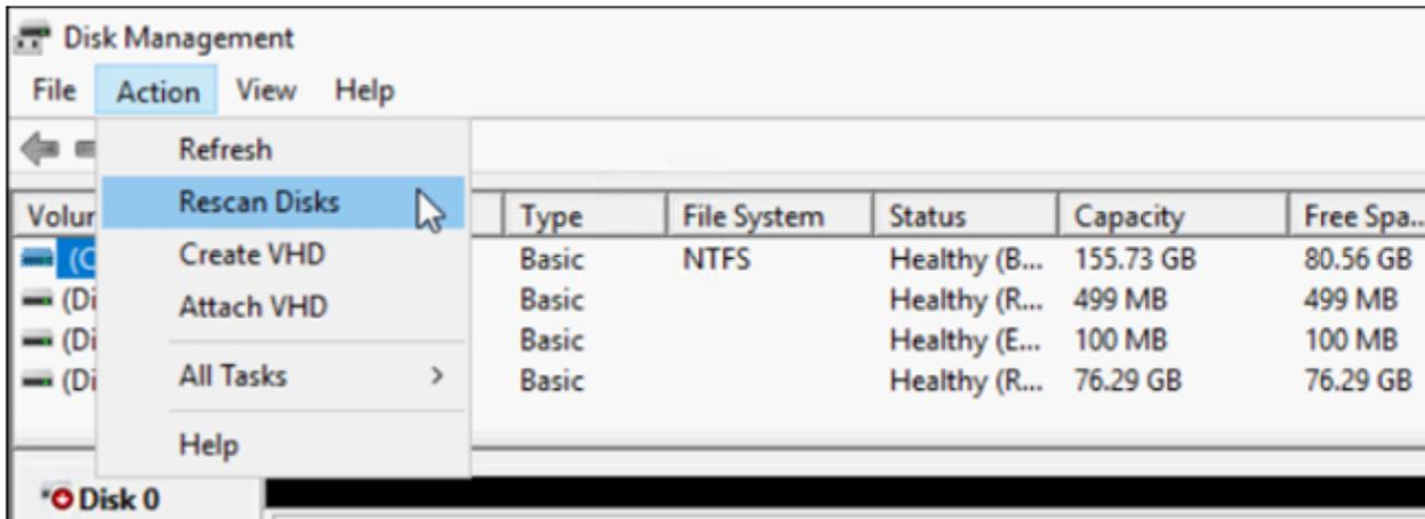
Después de volver a analizar los discos, el disco de la unidad de almacenamiento aparecerá con el almacenamiento expandido.
