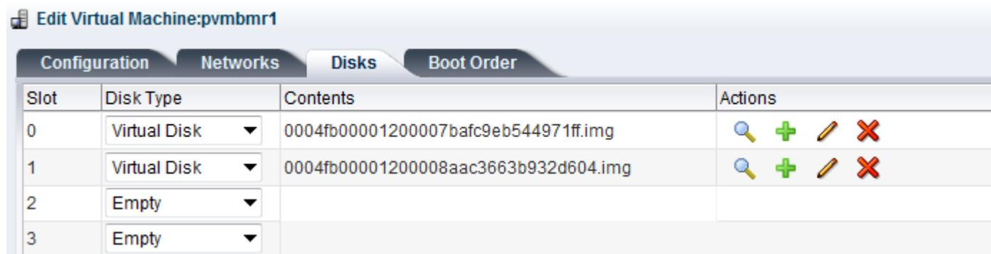
2. Sélectionnez le disque du logement N comme disque de démarrage.
