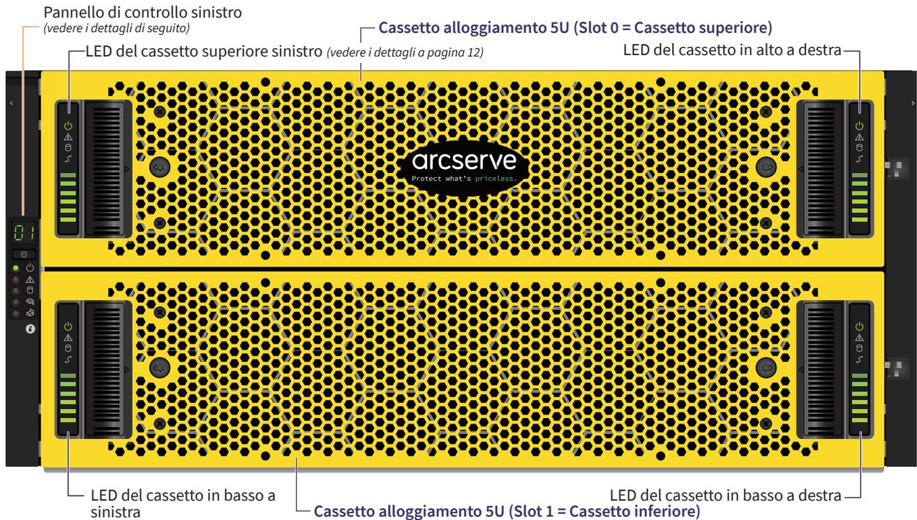
L'apertura di un cassetto non interrompe il funzionamento del sistema di archiviazione. I DDIC possono essere sostituiti a caldo mentre l'alloggiamento è in funzione. Tuttavia, i cassette non devono essere lasciati aperti per più di due minuti. In caso contrario, il flusso d'aria e il raffreddamento saranno compromessi.
