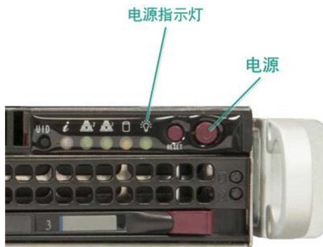
**注意：**主电源开关用于给设备通电或断电。使用此按钮关闭设备会切断主电源，但仍提供备用电源。因此，您必须在进行维护之前拔下设备的电源插头。
