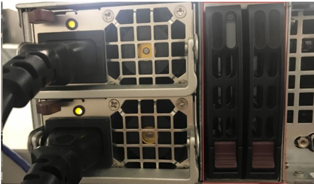
11. 開啟設備擴充架的電源。連接設備擴充架的電源線，並開啟設備擴充架的電源。
