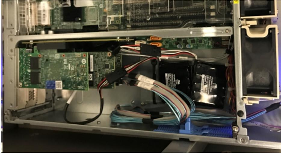
7. 將 *MegaRAID Controller 9380-8e* 托架固定到系統的底座。
