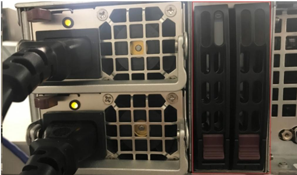
11. Encienda el estante de expansión del dispositivo. Conecte los cables de alimentación del estante de expansión del dispositivo y encienda el estante de expansión del dispositivo.
