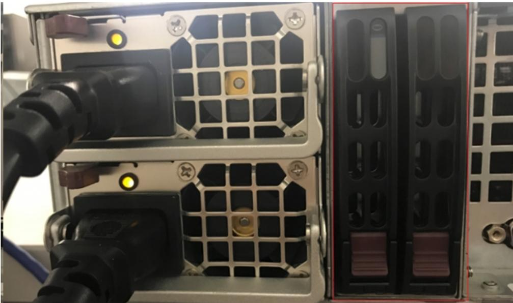
11. Mettez l'emplacement d'extension de l'appliance sous tension. Connectez les cordons d'alimentation de l'emplacement d'extension de l'appliance et mettez-le sous tension.
